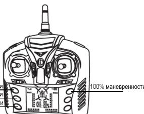
Пульт поддерживает 4 типа режимов чувствительности управления, который можно переключить с помощью кнопок на пульте 40% - режим для обучения полётам, в этом режиме модель менее чувствительна к ручкам управления. 60%, 80% и 100% - режим для продвинутых пилотов, в этом режиме модель более чувствительна к ручкам управления.
